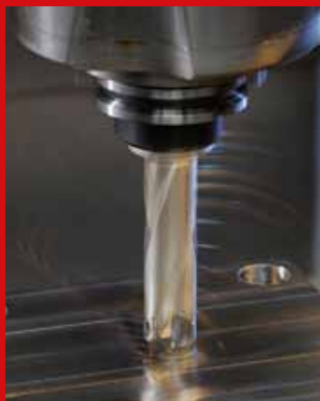
Hållare och vändskär för borrar.
